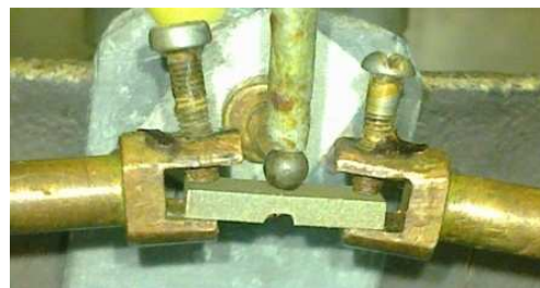
Рис. 5. Схема и общий вид измерения остаточных напряжений методом травления образцов на установке АПООН
