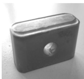
Рис. 6. Эскиз пластины формы LNUX301940 с канавками эллиптической формы и лунками, копирующими форму передней поверхности износа
