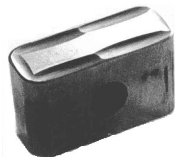
Рис. 7. Восстановление режущей части твердосплавных пластин типа LNUX301940: a – до обработки; б – после обработки
