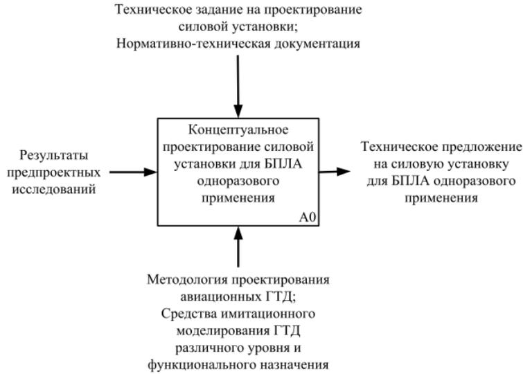
Рис. 3. IDEF-0 диаграмма верхнего уровня для концептуального проектирования силовой установки БПЛА
