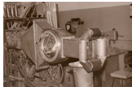
Рис. 20. Стенд для аэродинамических исследований плоских решеток S-образных профилей
