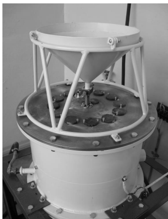
Рис. 26. Фотография стенда для сравнительных испытаний эрозионной стойкости материалов и покрытий
