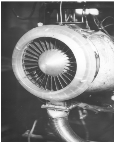
Рис. 18. Фотография самовращающегося роторного воздухоочистителя, выполненного для испытаний с подачей пыли
