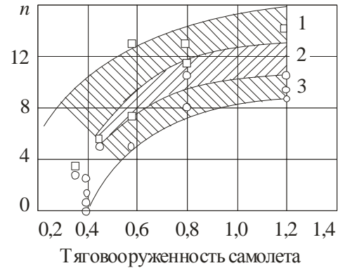
Рис. 4. Влияние тяговооруженности самолета на число ( n ) полных перемещений ручки управления двигателем за полет: 1 – атака наземных целей; 2 – преодоление зоны; 3 – воздушный бой
