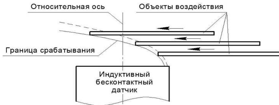
Рис. 6. Граница срабатывания индуктивного датчика
