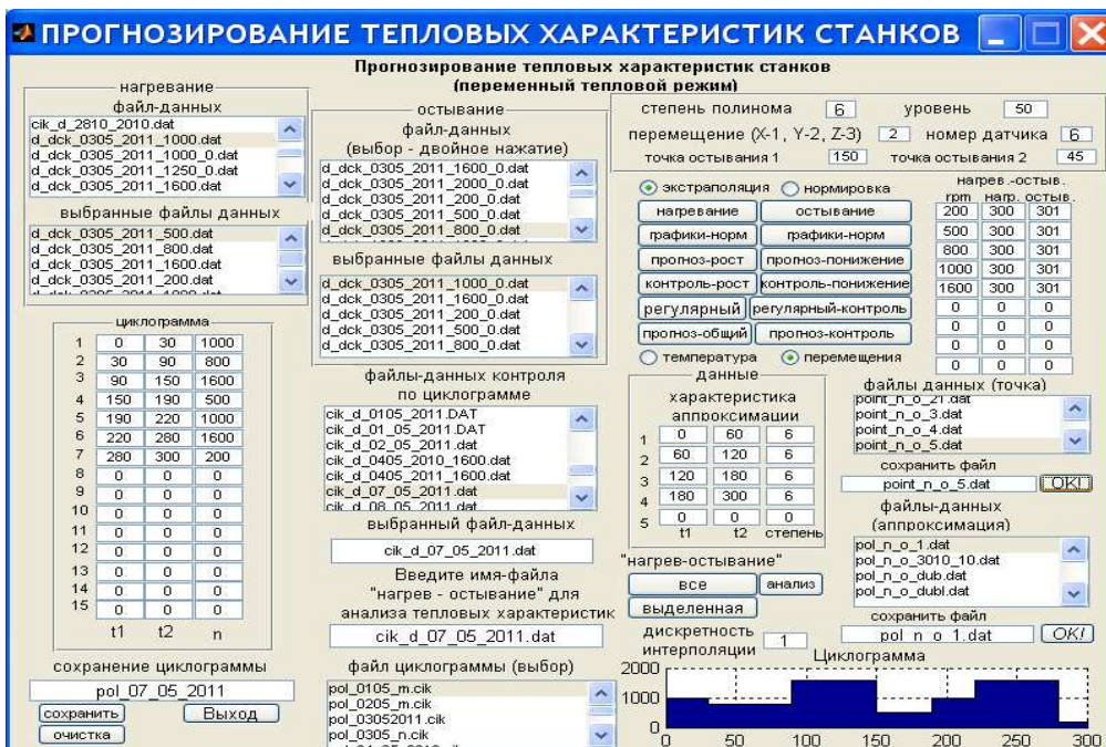
Рис. 6. Экранная форма программного модуля прогнозирования тепловых характеристик станков
