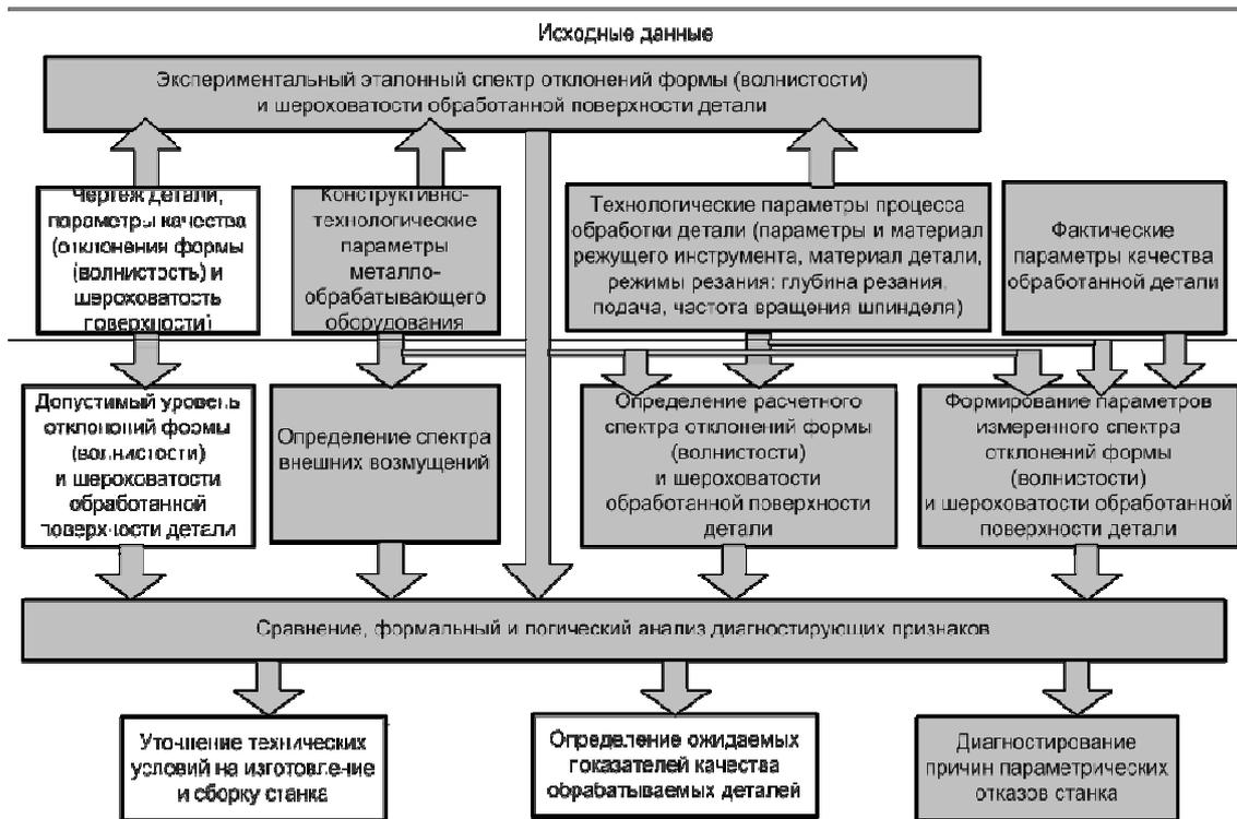
Рис. 3. Алгоритм оперативной диагностики приводов подач металлообрабатывающего станка
