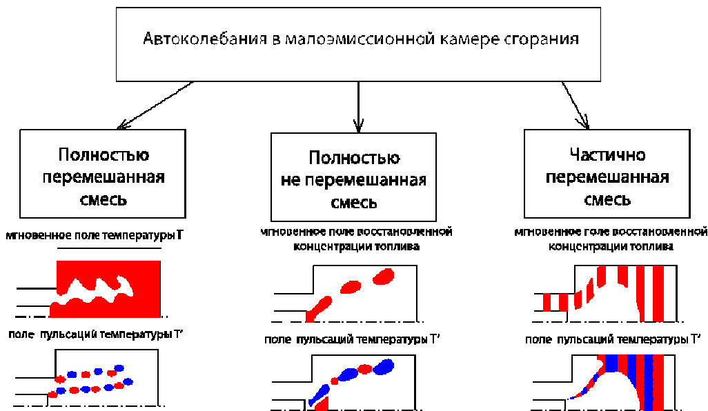
Рис. 2. Механизмы возбуждения автоколебаний в малоэмиссионной камере сгорания
