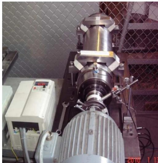
Рис. 1. Общий вид шпиндельного узла, установленного на стенде
