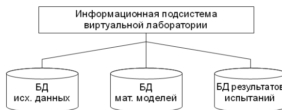
Рис. 3. Структура информационной подсистемы виртуальной лаборатории испытаний ГТД
