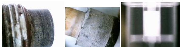
Рис. 15. Состояние материала со свечи Champion после проведения испытаний в макетах
