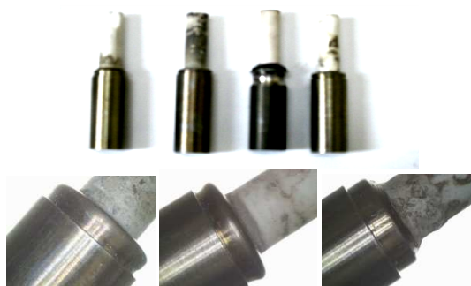
Рис. 7. Узлы после испытаний на термическую стойкость
