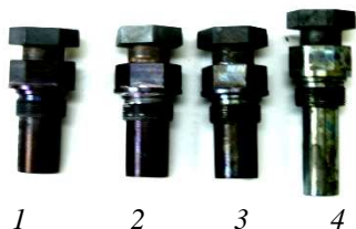
Рис. 13. Макеты после испытаний: 1 – глиноземо-тальковый состав, 2 – материал со свечи Champion, 3 – модифицированный глиноземо-тальковый состав, 4 – новый материал графлекс
