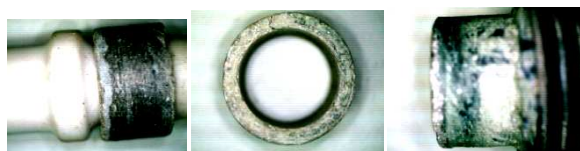
Рис. 17. Состояние деталей после разборки узла, подвергнутого испытаниям
