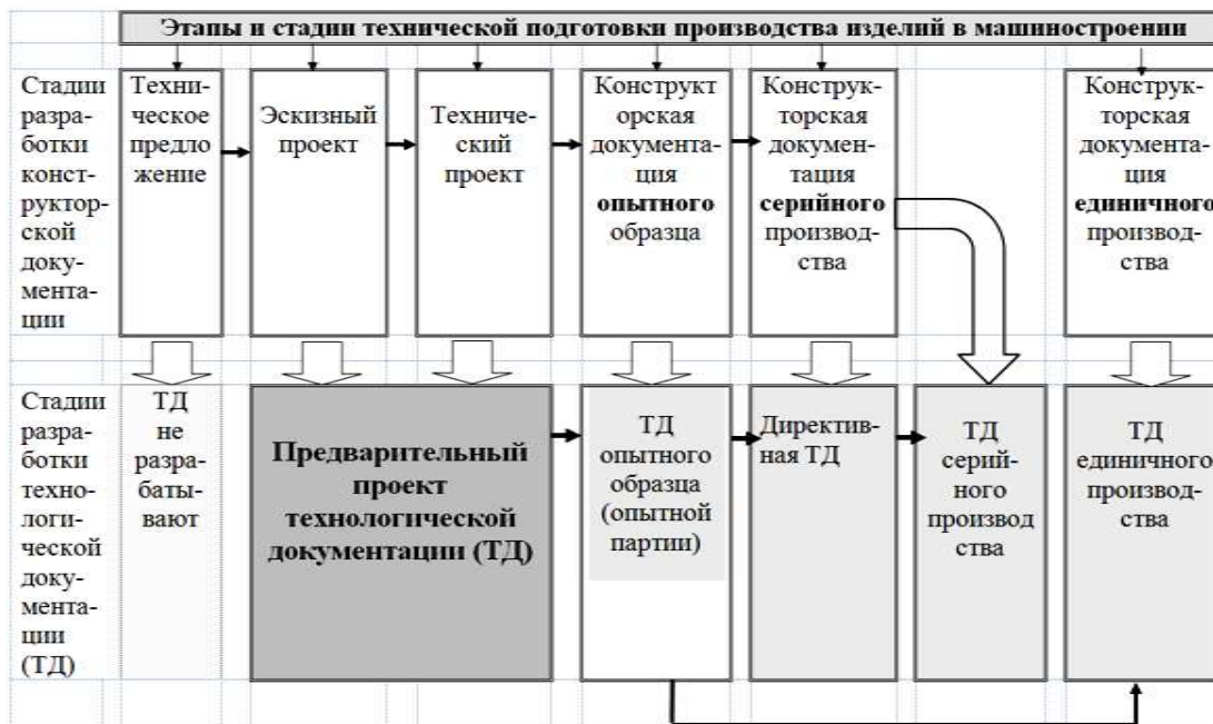
Рис. 1. Схема взаимосвязей разработки конструкторской и технологической документации по ЕСКД и ЕСТД
