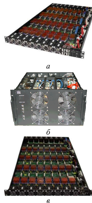
Рис. 2. Вычислительные модули нового поколения: а – вычислительный модуль «Орион-5»; б – вычислительный модуль «Саиф»; в – вычислительный модуль «Ригель»
