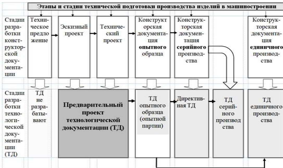
Рис. 3. Схема взаимосвязей разработки конструкторской и технологической документации по ЕСКД и ЕСТД
