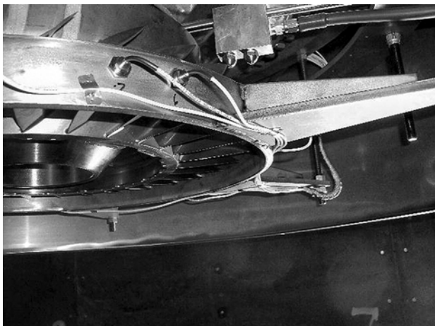
Рис. 4. Оснастка для возбуждения колебаний блиска первой ступени компрессора высокого давления
