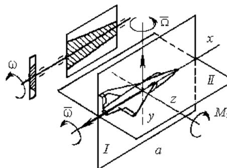
Рис. 1. Схема направлений действия гироскопического момента для одного из видов эволюции самолета [1]
