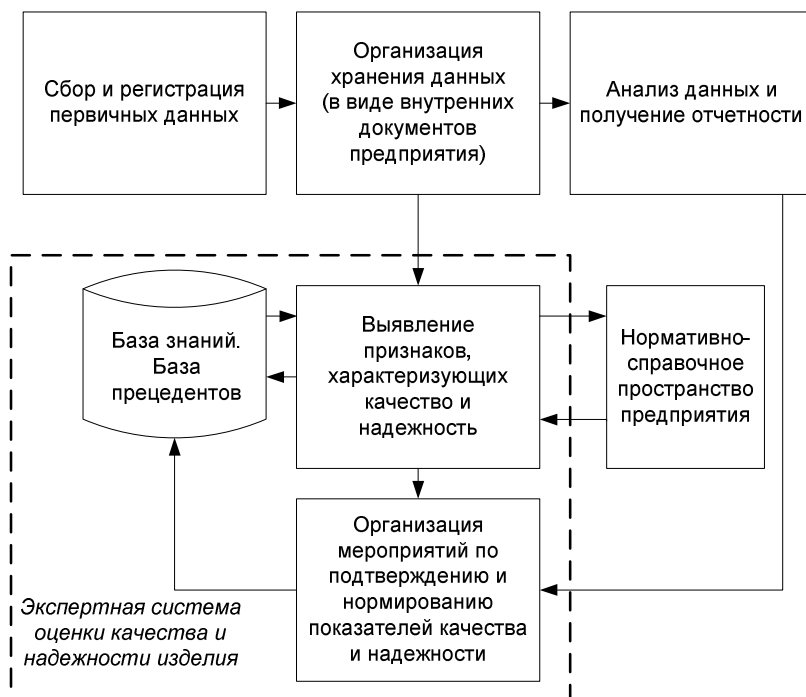
Рис. 4. Структура системы сбора, обработки и анализа эксплуатационных данных
