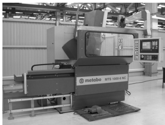
Рис. 1. Шестикоординатный лентошлифовальный станок Metabo 6NC – 1000
