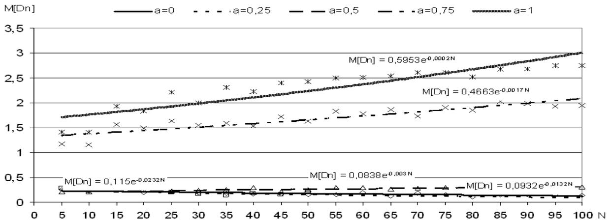
Рис. 5. Оценивание  $F(x_{\max})$  при экспоненциальном законе распределения и разных коэффициентах помехи  $a$
