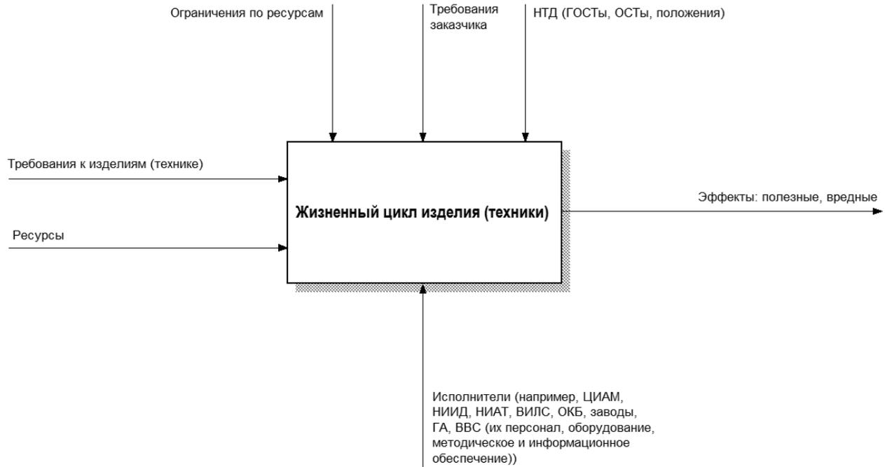
Рис. 1. Верхний уровень функциональной модели жизненного цикла изделия
