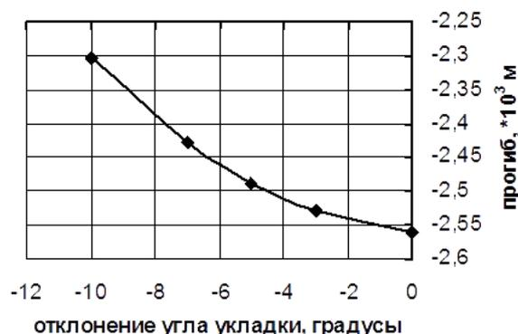
**Рис. 5.** Зависимость прогиба консольной девятислойной балки из углепластика от отклонения угла укладки девятого слоя от сбалансированного состояния (45°) в сторону уменьшения
