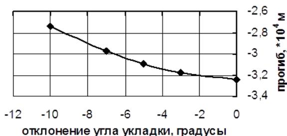
**Рис. 3.** Зависимость прогиба двухопорной девятислойной балки из углепластика от величины отклонения угла укладки девятого слоя от сбалансированного состояния (45°) в сторону уменьшения
