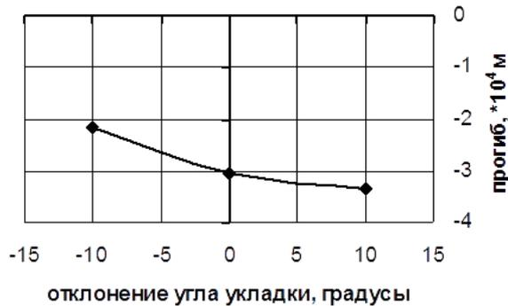
**Рис. 7.** Зависимость прогиба двухопной пятислойной балки из углепластика от отклонения угла укладки пятого слоя от сбалансированного состояния ( $45^\circ$ )
