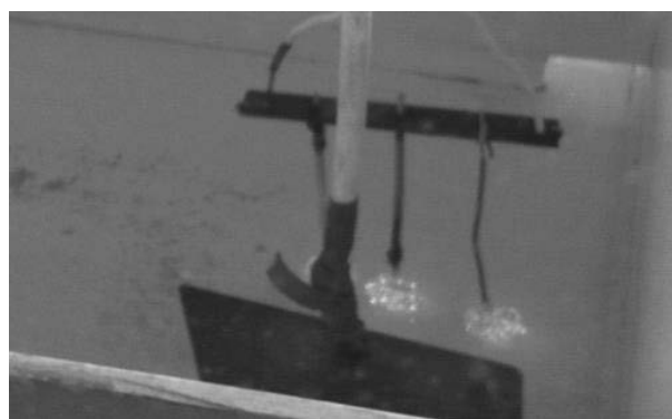
Рис. 2. Образцы в процессе МДО
