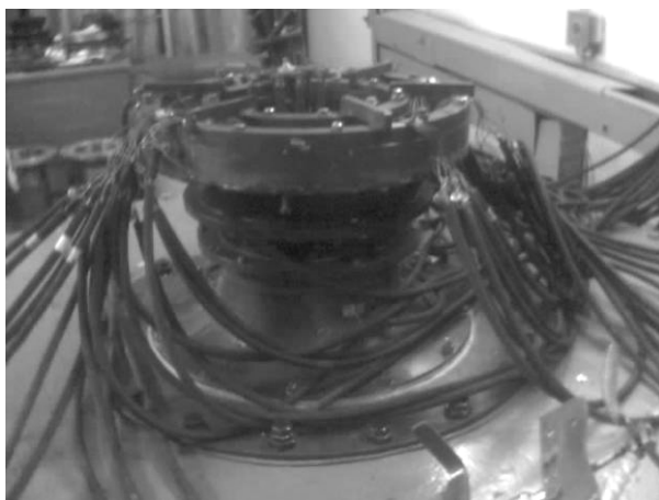
Рис. 2. Экспериментальная установка межтурбинного переходного диффузора вместе с СА ТВ на аэродинамическом стенде
