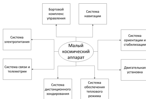
Рис. 1. Состав малого космического аппарата
