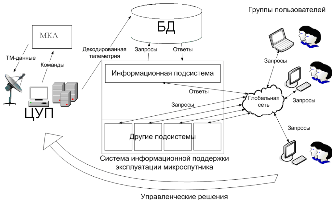
Рис. 4. Схема работы системы информационной поддержки в процессе эксплуатации
