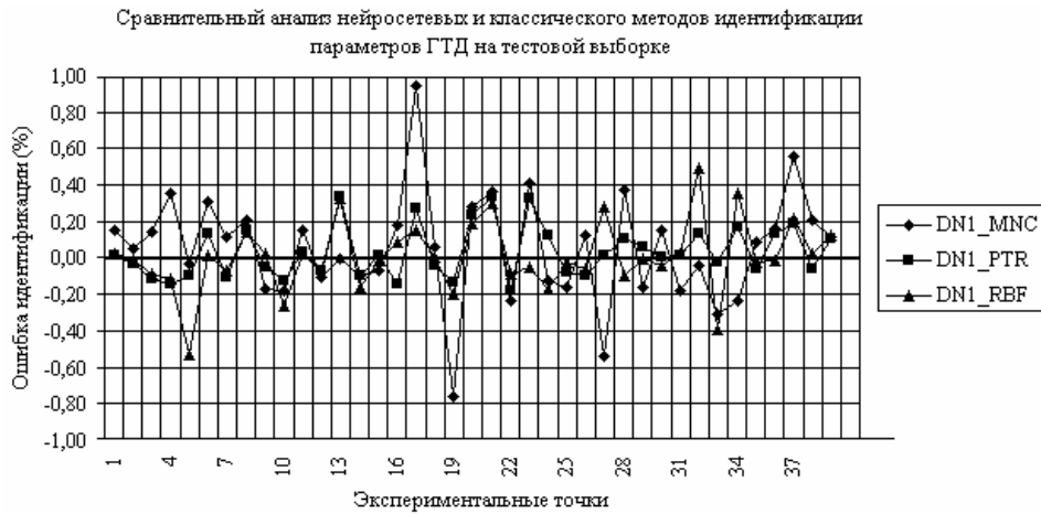
Рис. 10. Анализ погрешности модели ГТД для различных методов идентификации
