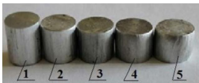
**Рис. 3.** Образцы из сплава D16: 1 – до деформации; 2 – деформированные без смазки; 3 – с применением смазочного материала «Lubrodal F318N»; 4 – с применением «Росойл-Синтезол»; 5 – с применением «Росойл-318»
