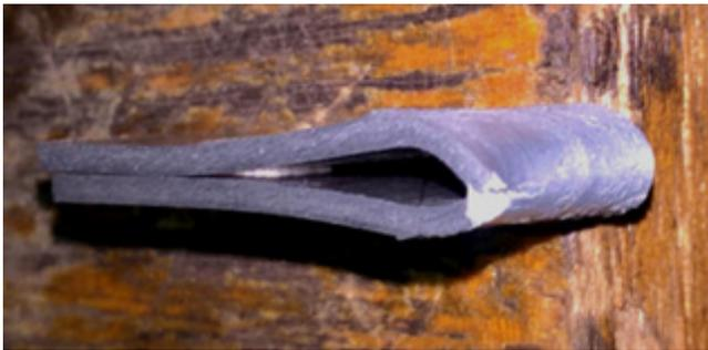
Рис. 7. Образец с трещиной при угле изгиба более  $150^\circ$
