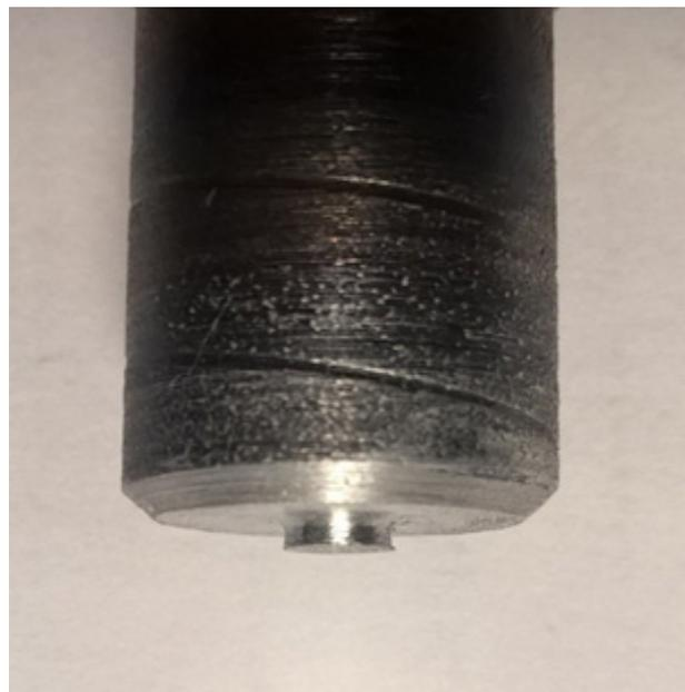
Рис. 1. Инструмент для СТП сплава АМГ2М толщиной 1,5 мм
