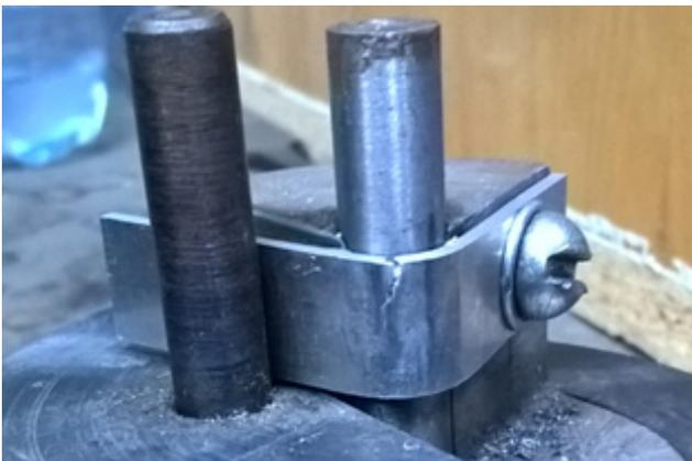
Рис. 8. Образец с трещиной, проявившейся при угле  $95^\circ$
