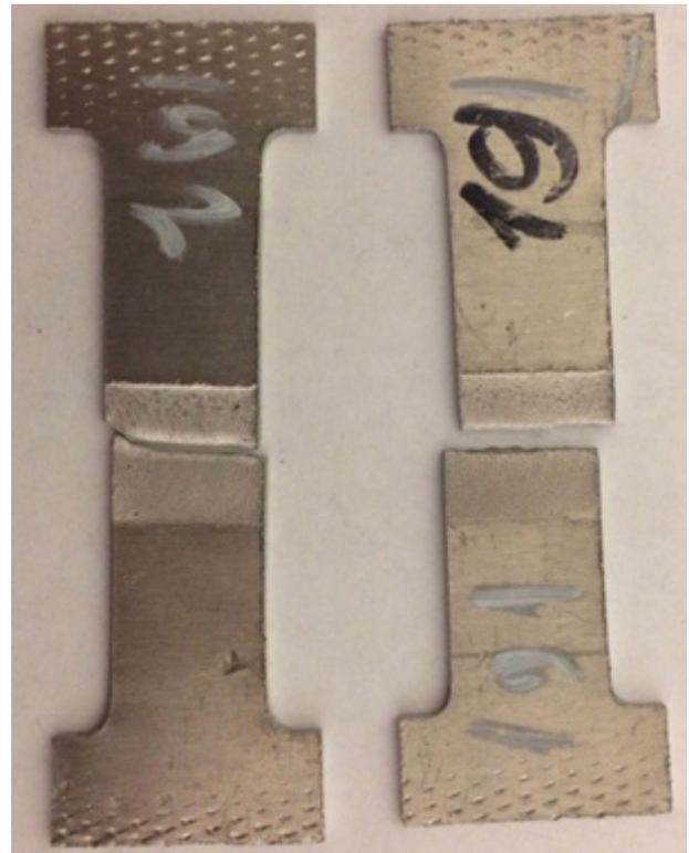
Рис. 10. Разрушение образцов по сварному шву
