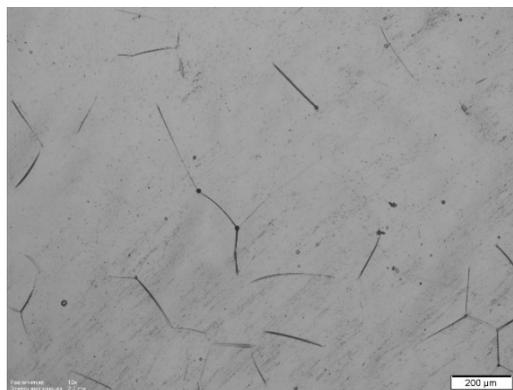
**Рис. 2.** Микроструктура образца Ti-10Mo-8Nb-6Zr после закалки
