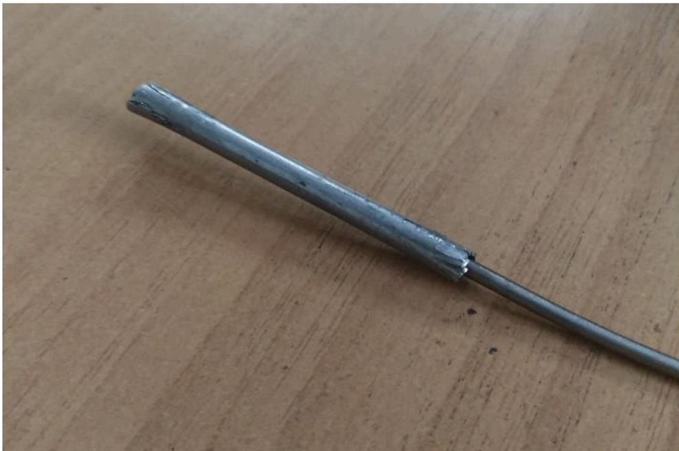
**Рис. 6.** Экспериментальный образец трубки из сплава Zn-4Ag-Cu
