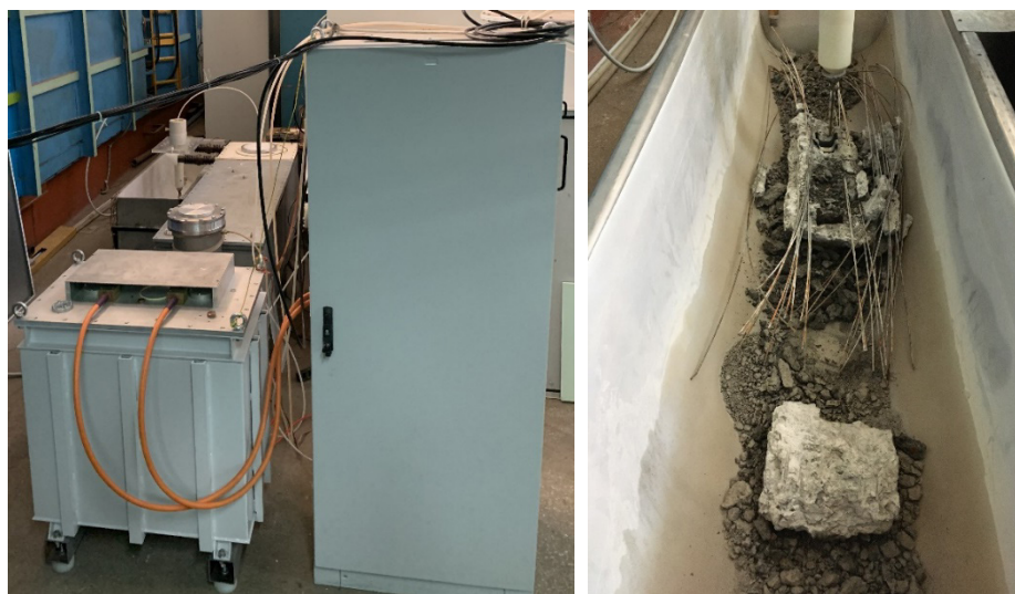
Рис. 10. Установка для электроразрядного разрушения железобетонных изделий (слева) и водозаполняемый объем с разрушенной железнодорожной шпалой (справа)
