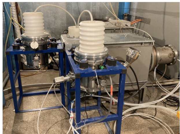
Рис. 8. Установка с двумя параллельными камерами дробления
