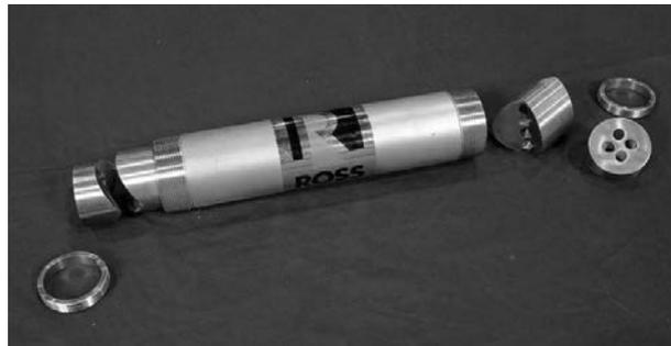
Рис. 4. Смеситель типа *ISG* (Конструкция с каналами и отверстиями) [6]
