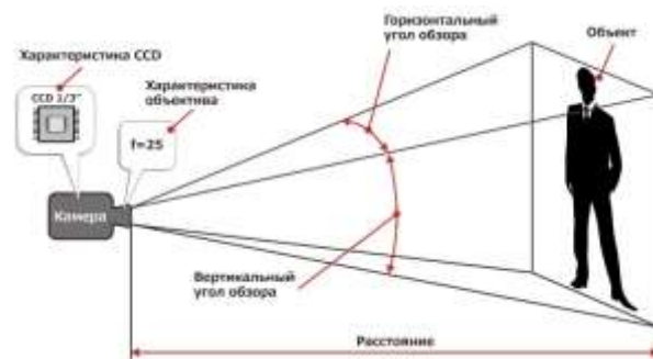
Рис. 1. Горизонтальный и вертикальный углы обзора камеры
