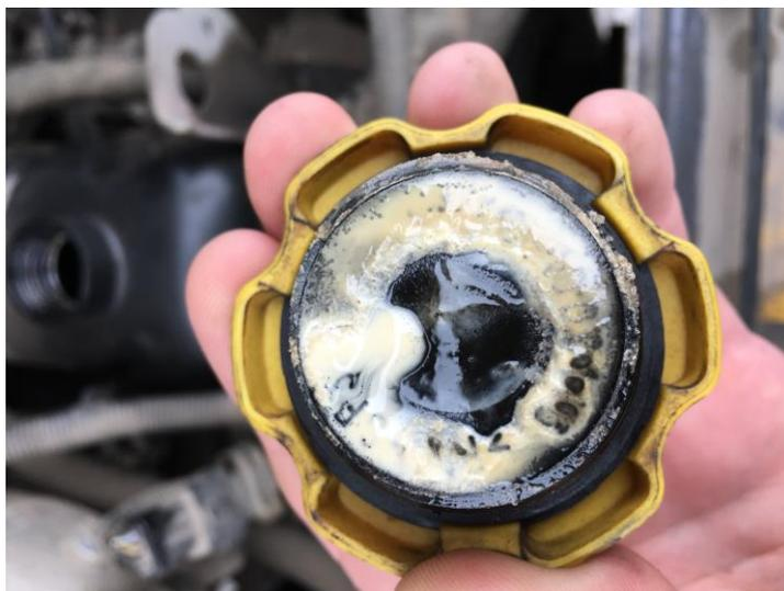
Рис. 5. Эмульсия на маслозаливной пробке
