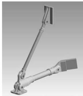
Рис. 3. Опора подредукторной рамы
