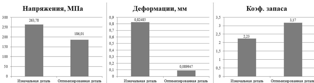
Рис. 5. Результаты расчетов исходной и оптимизированной детали
