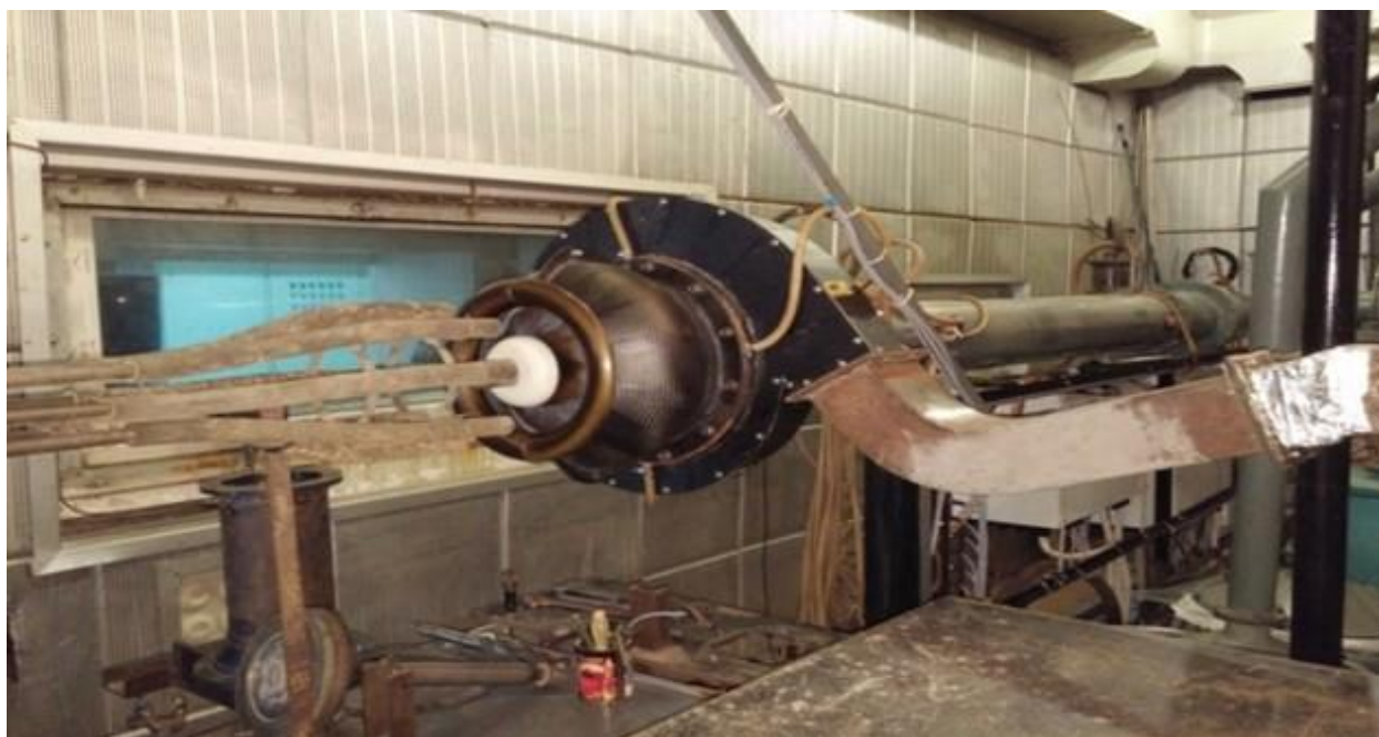
Рис. 1. Общий вид собранного ПЗУ с «улиткой» на испытательном стенде
