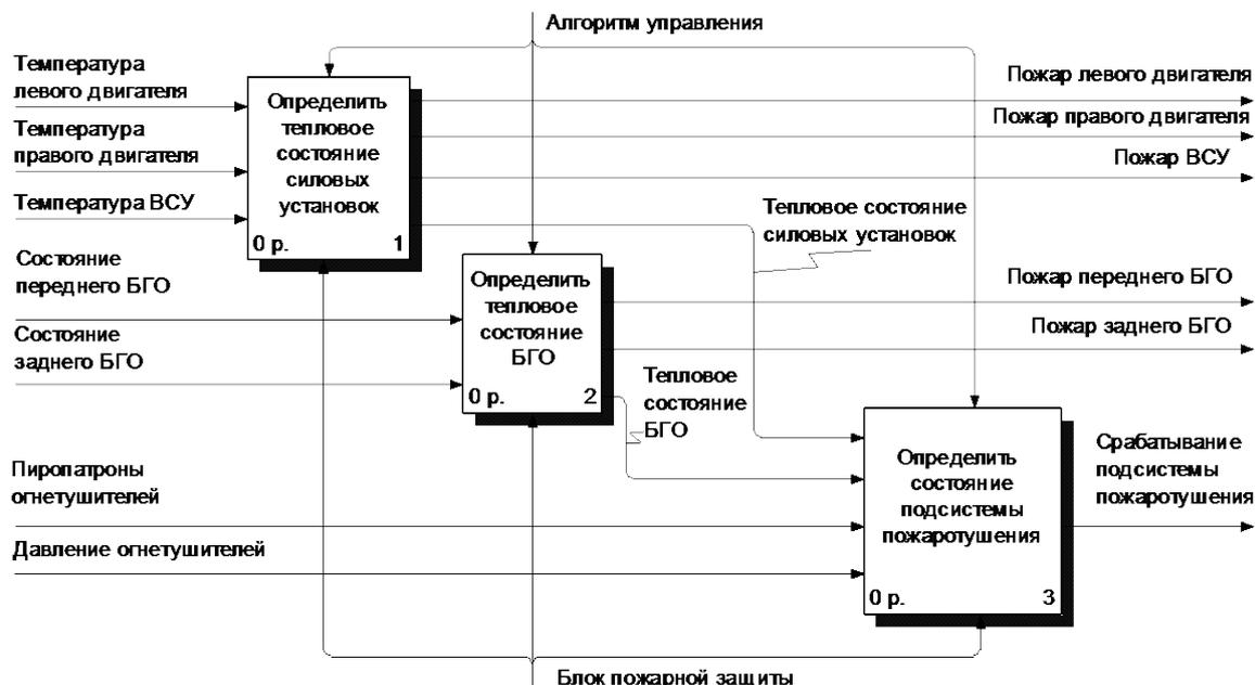
Рис. 1. Мнемосхема системы пожарной защиты самолета
