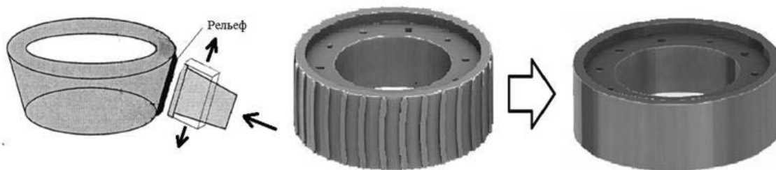
Рис. 1. Существующая и перспективная схема ЛСТ блиска
