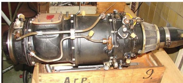
Рис. 1. Внешний вид турбостартера ТС -21
