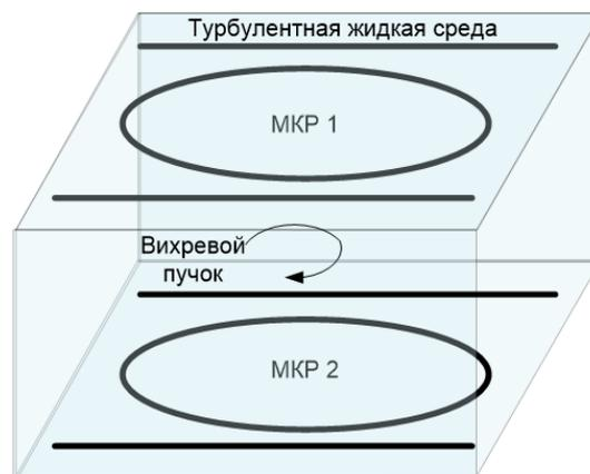
Рис. 7. Эскиз сенсорной системы с использованием вихревого пучка для определения показателя преломления
