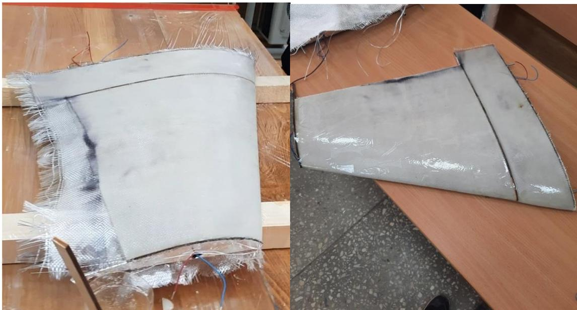
Рис. 3. Этапы изготовления крыльев беспилотного летательного аппарата
