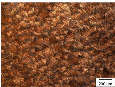
Рис. 1. Микроструктура сплава АК9 после 3D печати
