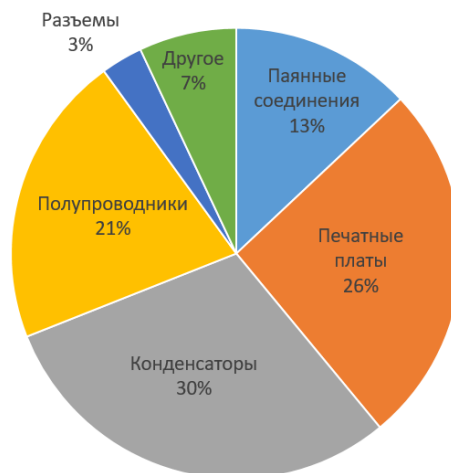
Рис. 2. Доля отказов групп компонентов электронного блока
