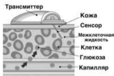
Рис. 1. Схема работы малоинвазивного глюкометра.
