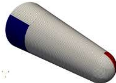
Рис. 2. Вычислительная сетка микропробирки.
